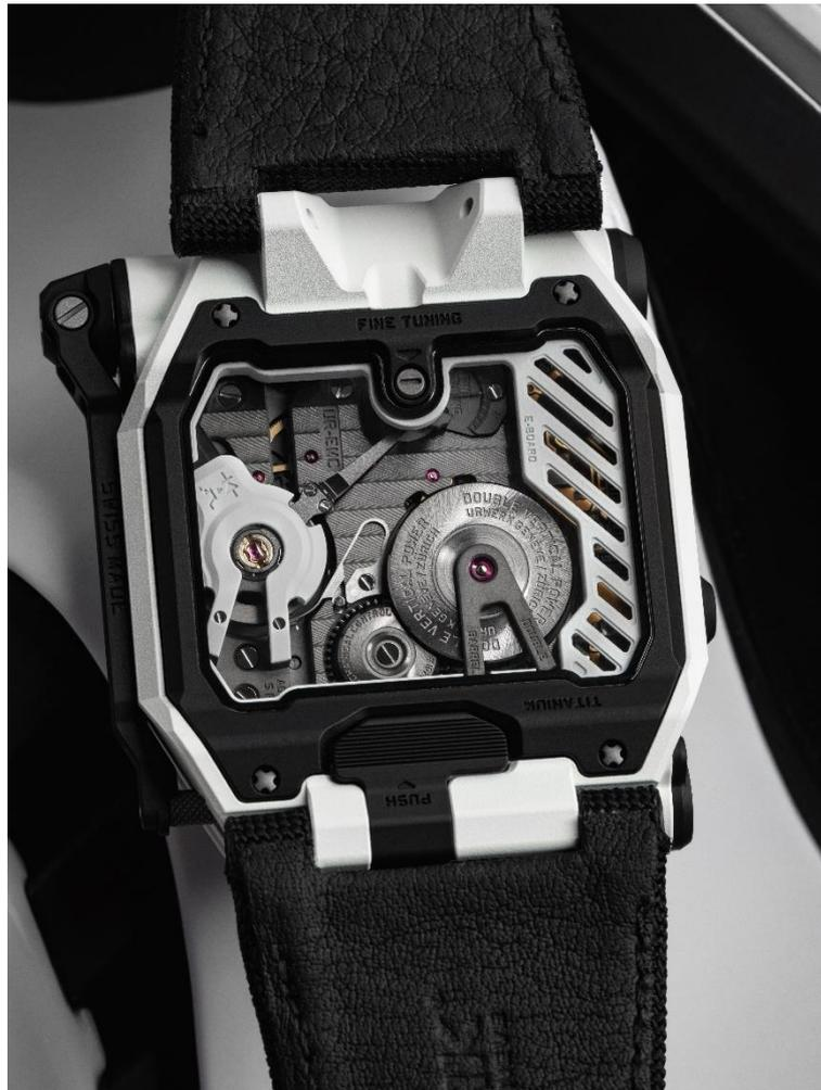
與此同時，一個電子系統負責測量機械機芯的準確度，該系統有獨立電源，與機芯動力來源分隔。錶殼側有伸縮槓桿，可手動發電為感應電路板提供電力。電路板對準擺輪，其激光二極體可以收集兩種重要的機芯數據，分別為擺輪的擺幅（顯示機芯運作是否良好）以及快慢偏差（顯示機芯運作精確度），兩個數據與另一個作基準的 16MHz 電子石英共振器對比，可以得出精準量度數據。
